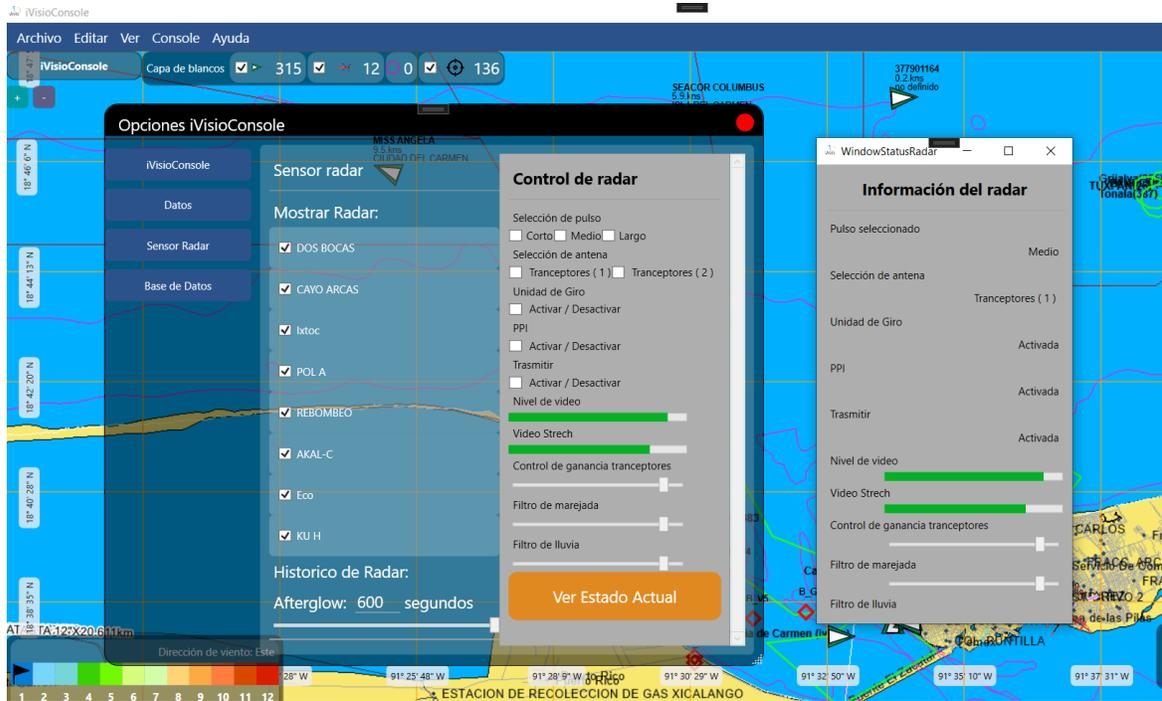
En imagen anterior se puede apreciar una nueva ventana en la cual se presentan el estado de los sensor de radar seleccionado.
