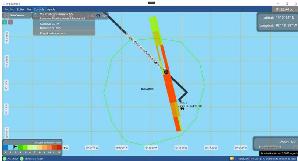
En iVisioConsole se auto tráquea el blanco a partir del video de radar, momento en que se puede visualizar dicha nave y la cámara lo sigue de forma automática, a partir del área de alcance de la cámara CCTV.
