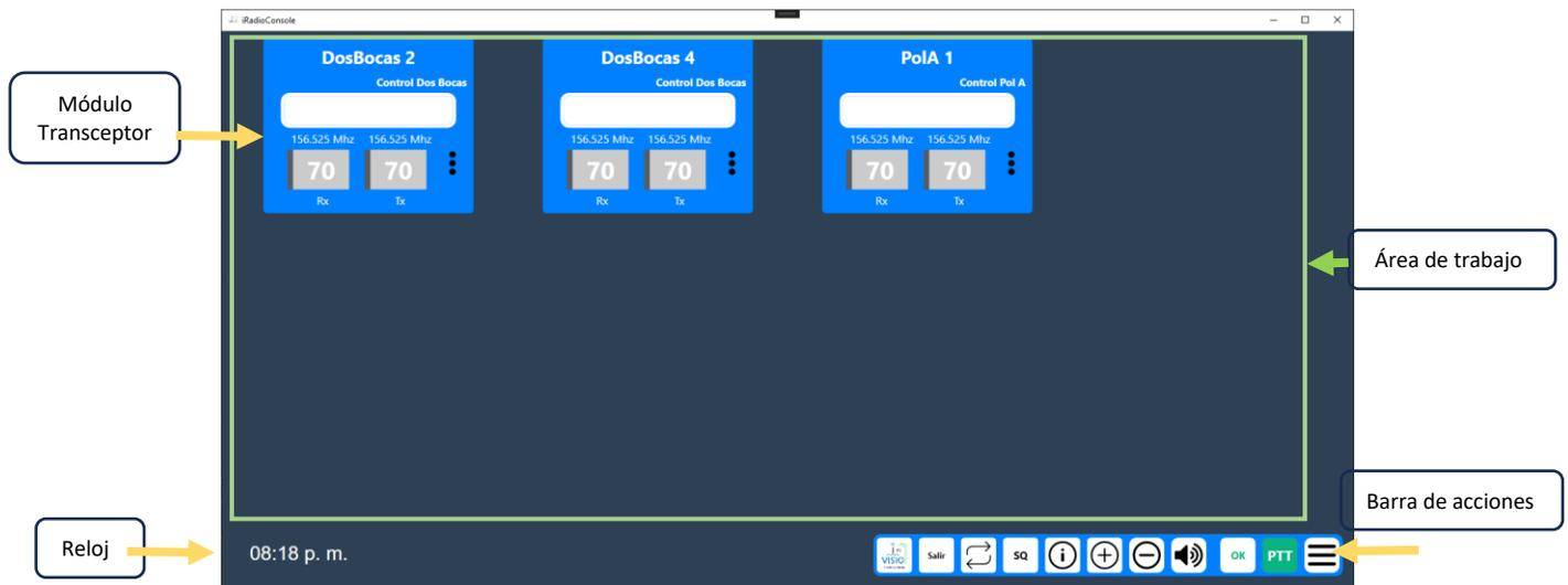
Ilustración 2 iVisioRadioConsole - Elementos de la interfaz de usuario
