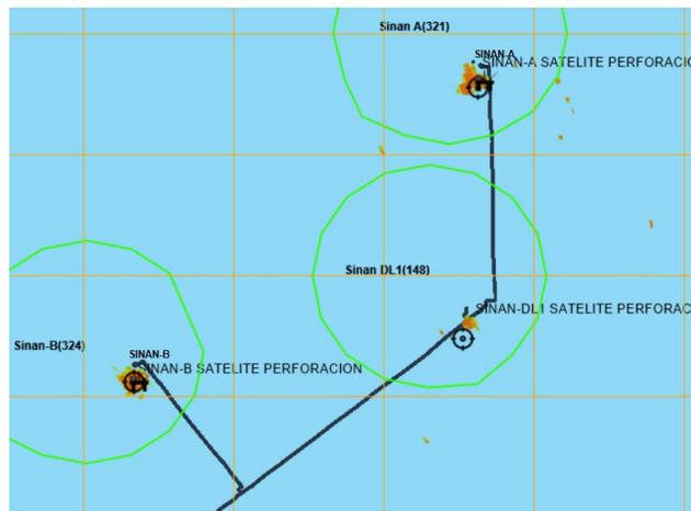
Video de rada fusionado de varias fuentes, permitiendo una definición detallada del video de radar
