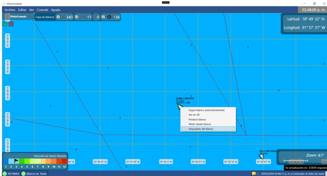
En la siguiente imagen se puede visualizar las etiquetas a mostrar y además el menú para personalizar etiquetas como el nombre, identificación e imo de la embarcación por parte del operador
